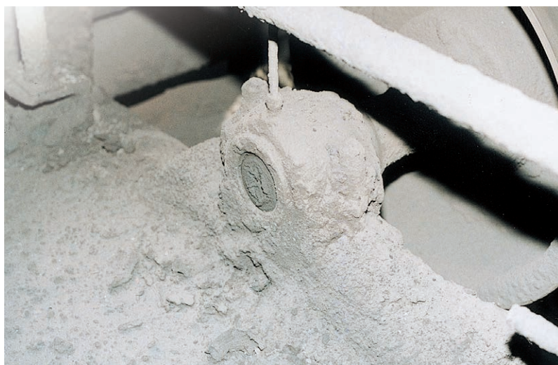
带轮用轴承 使用状态 (立式轴承座)
