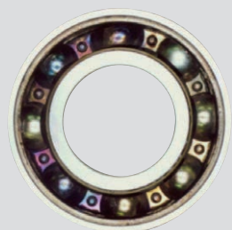
润滑脂封入轴承 (润滑脂流出后停止)
